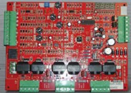
TARJETA PRINCIPAL DE CONTROL LÓGICO PARA HORNOS DE FUNDICIÓN CON POTENCIA HASTA DE 1000 KW Y RANGO DE FRECUENCIA HASTA DE 3,000 HERCIOS
